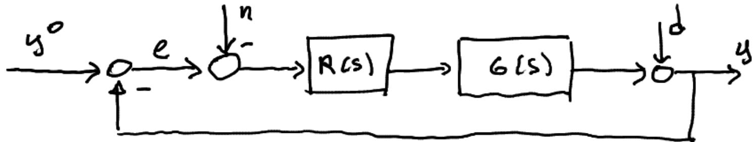
Scopo: progettare  $R(s)$  in modo che il sistema di controllo verifichi delle specifiche assegnate
